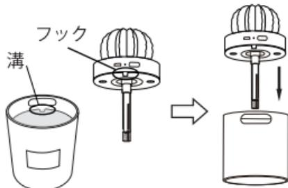
ふたのフックと水タンク内側の溝に合わせてふたを水タンクに装着する
