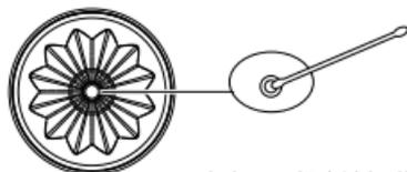
吹出口の超音波振動板は綿棒で拭き取る
